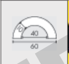
5 PGE320SW - paracolpi lunghezza 780 mm x 45 mm, peso 135 gr con biadesivo, colore bianco PGE320SWM - come sopra ma magnetico
