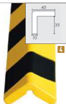
4 PGE322S - paracolpi lunghezza 780 mm x 45 mm, peso 135 gr con biadesivo, colore giallo/nero PGE322SM - come sopra ma magnetico
