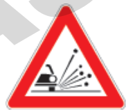
F.R 190 029 materiale instabile su strada
