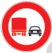
F.H. 260052 * divieto di sorpasso per i veicoli superiori a 3,5 t a pieno carico
