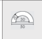
4 PGE322S - paracolpi lunghezza 780 mm x 45 mm, peso 135 gr con biadesivo, colore giallo/nero PGE322SM - come sopra ma magnetico
