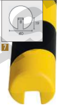
7 PGE420S - paracolpi lunghezza 780 mm x Ø 40 mm, peso 200 gr senza biadesivo
