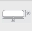
1 PGE425S - paracolpi lunghezza 780 mm x Ø 40 mm, peso 135 gr con biadesivo PGE425SM - come sopra ma magnetico
