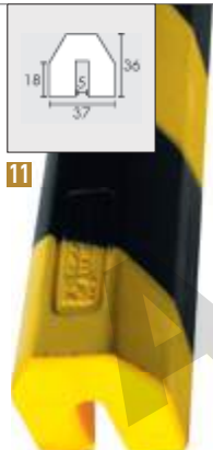
11 PGE121S - paracolpi lunghezza 780 mm x altezza 36 mm, peso 200 gr senza biadesivo
