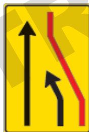
FCR 790411 A D segnalazione corsia chiusa (destra)
