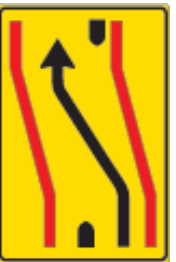
FCR 790412 A segnalazione carreggiata chiusa
