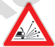
F.R 190 029 materiale instabile su strada
