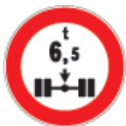
F.R. 261069 transito vietato ai veicoli aventi una massa per asse superiore a ... t
